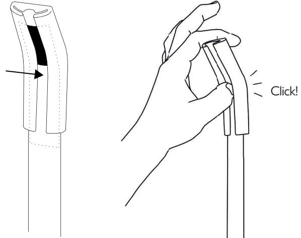
**2** Einschiebehilfe ausrichten und das Maßband über der Einschiebehilfe in den Schlitz führen.
