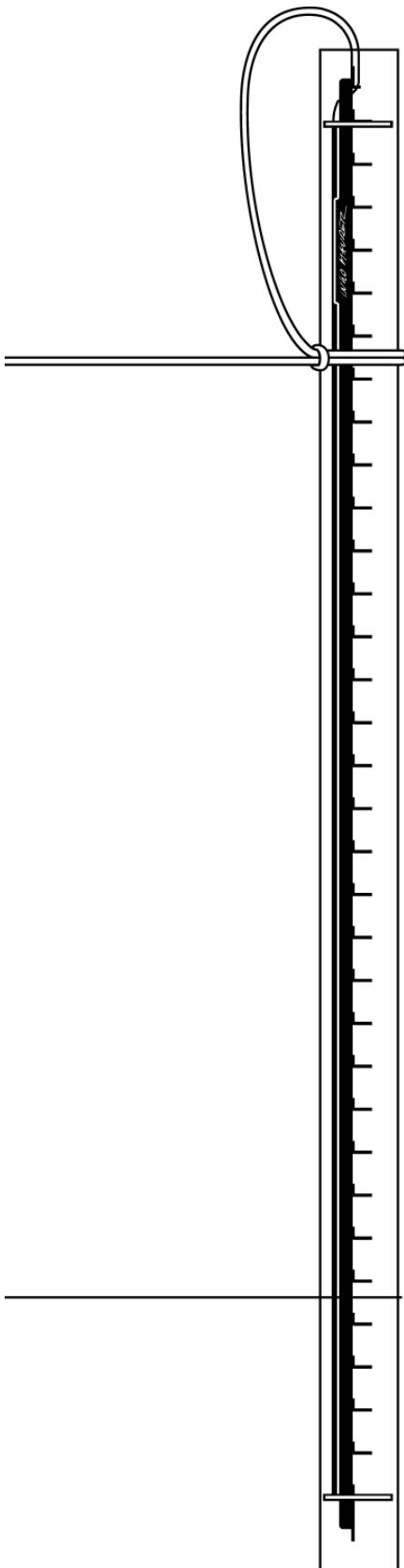
8. Metalllammelle demontieren / Extract the metal diffuser / Démonter la lamelle métallique / Smontare il diffusore di metallo
